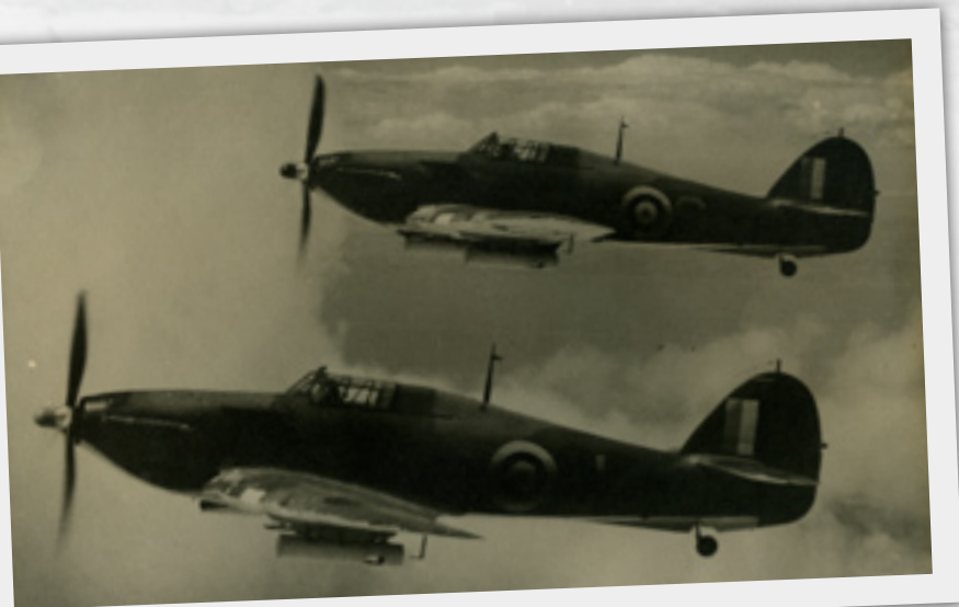
Deux Hurricanes près de la côte de Terre-Neuve. Ces avions, équipés de deux grenades sous-marines de 250 livres, faisaient des patrouilles de sous-marins sur la côte de Terre-Neuve. Le Dr. MacKenzie pilotait l'avion du haut de cette image au moment où la photo a été prise.
